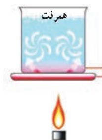
شکل ۸- آب گرم شده به سمت بالا حرکت می‌کند و آب سرد جای آن را می‌گیرد.
