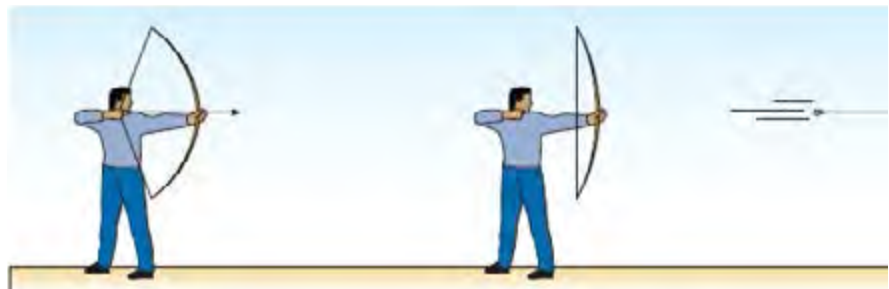
شکل ۷-ب - کمان کشیده شده دارای انرژی پتانسیل کشسانی است. بارها کردن زه (کش) کمان، انرژی پتانسیل ذخیره شده به انرژی جنبشی تیر تبدیل می شود.
