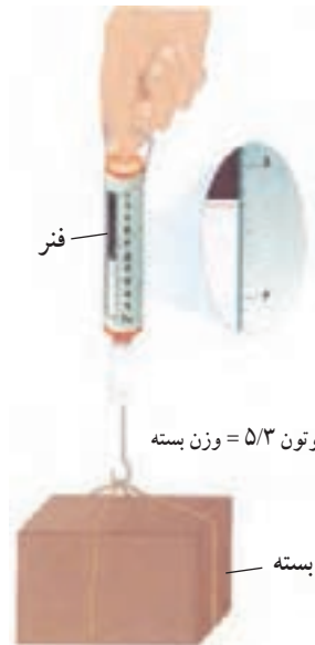
شکل ۲- با نیروسنج وزن یک جسم را اندازه‌گیری می‌کنیم.
